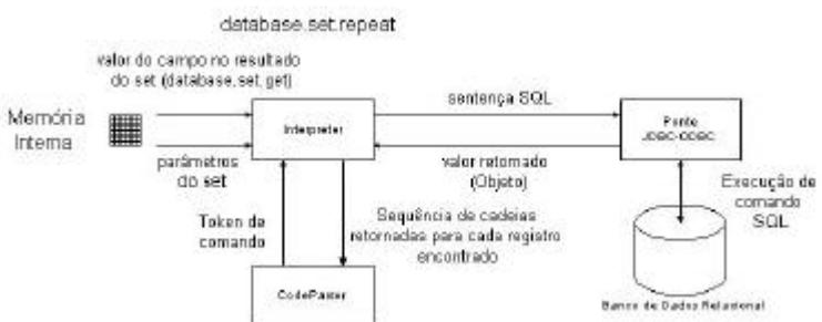
Figura 4: Esquema de execução do comando **database.set.repeat** e **database.set.get**.
